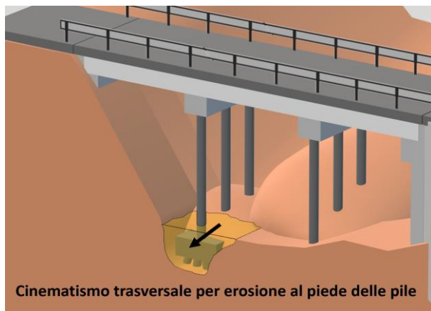
Figura 2. Frane di dimensioni limitate che interessano localmente le pile o le spalle.
