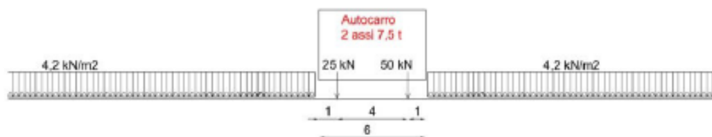
Figura 6.3 – Possibile distribuzione di carico corrispondente ad un mezzo di 75 kN
